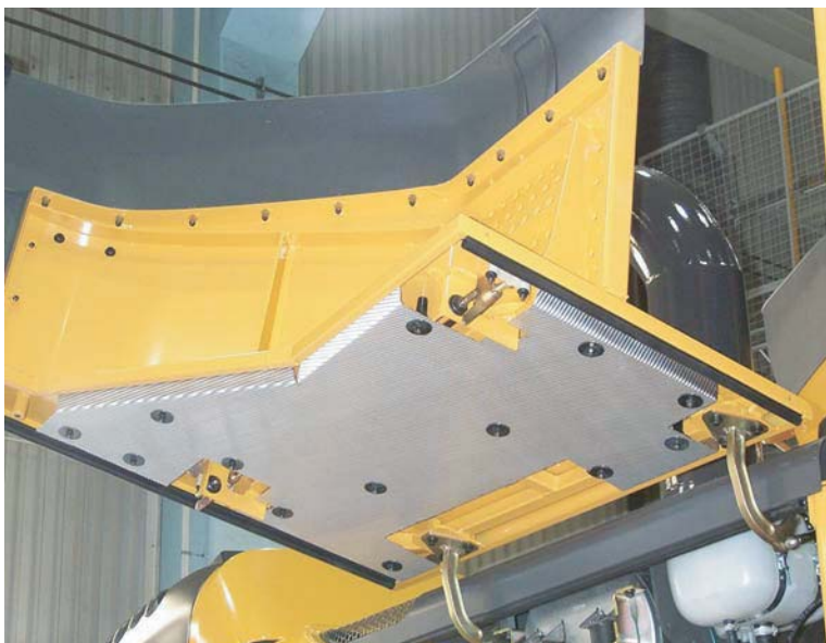
Auf den Klappbaren Teil der Motorhaube montiertes Acustimet
