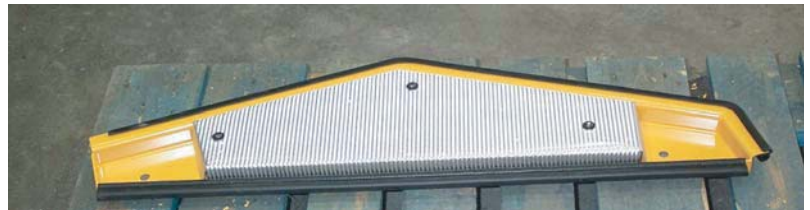
Auf den geschraubten Teil der Motorhaube montiertes Acustimet
